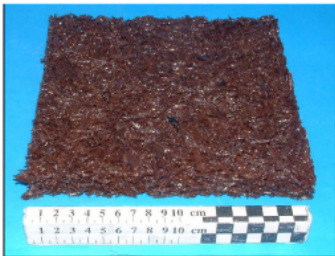
N° 3: Aglomerado coloreado, espesor 20 mm (ref. FIBRAS LARGAS: fibras de caucho)
